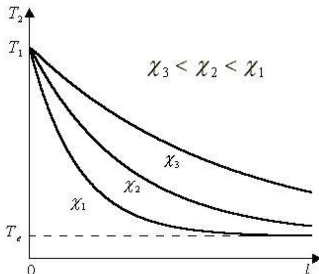
**Рис. 3. Графики зависимости  $T_2$  от длины при различных коэффициентах внешнего теплообмена.**
