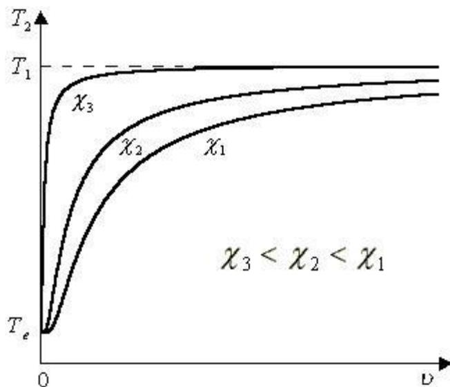
**Рис. 2. Графики зависимости  $T_2$  от скорости при различных коэффициентах внешнего теплообмена.**
