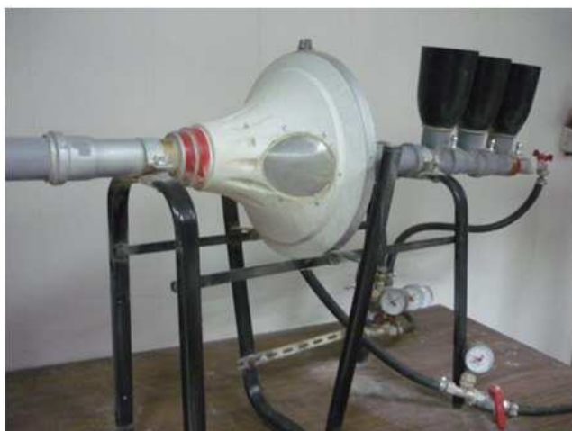
а) б) Рисунок 1. Пневмосмеситель непрерывного действия: а) – общий вид экспериментальной установки; б) – камера смешения пневмосмесителя.
